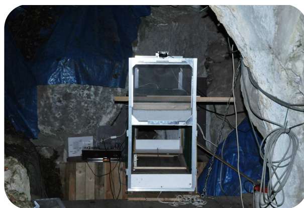
Tunnel de capture in situ, muni de ses deux fermetures automatiques
